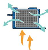
Im Keramikwabenfilter wird die Luft gründlich gereinigt. Ein leiser Lüfter befördert die gereinigte Luft in den Raum zurück.
